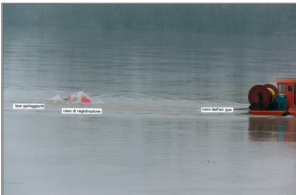
**Fig. 6.4.1 - Registrazione del rilievo sismico**
