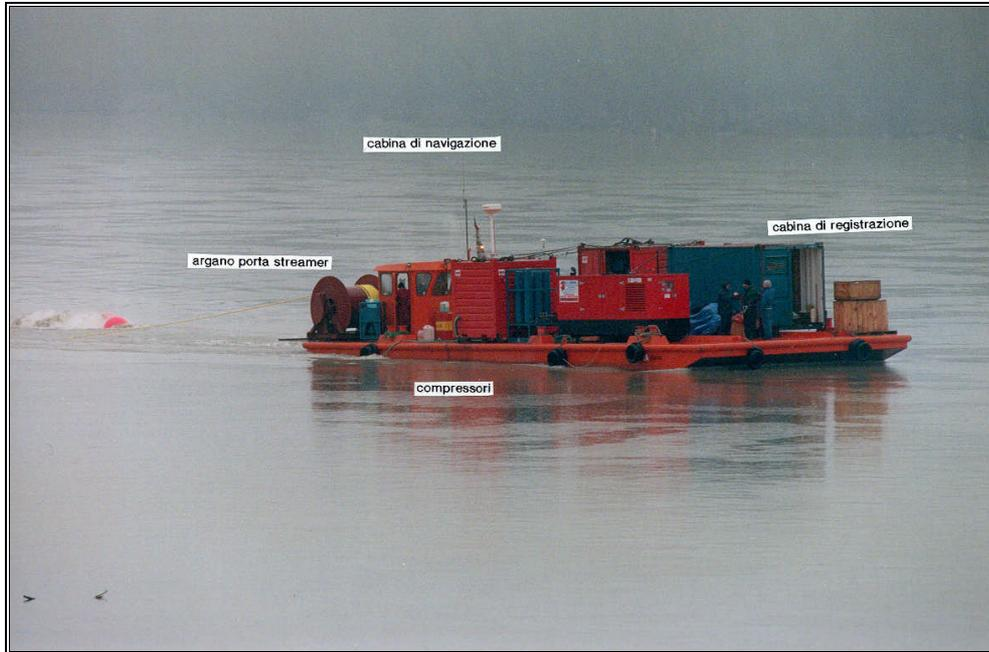
**Fig. 6.2a - Pontone con l'attrezzatura per l'acquisizione sismica**
