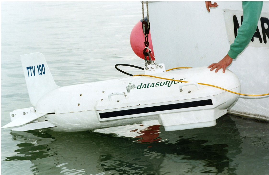
Fig. 3.4.4b - Generatore del segnale per rilievo SSS&SBP tecnologia "CHIRP"
