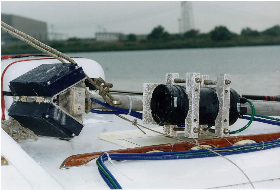
Fig. 3.4.1a - Sistema interferometrico "Swath Bathymetry"
