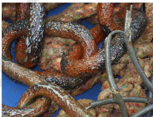
Figure 26. Recupero boa E1, spezzone di catena arrugginita, a circa 3 m sotto la boa, R/V Mariagrazia , LTES1-10.
