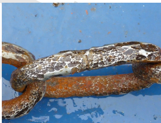
Figure 27. Recupero boa E1, spezzone di catena arrugginita, a circa 3 m sotto la boa, R/V Mariagrazia , LTES1-10.
