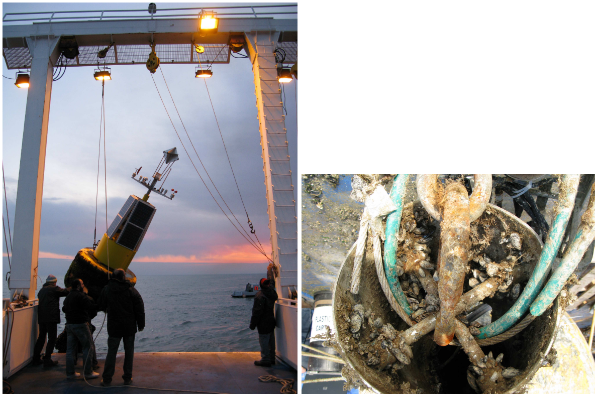
Figura 10: Boa S1, intervento di recupero. A destra la situazione del sistema di ormeggio principale.
