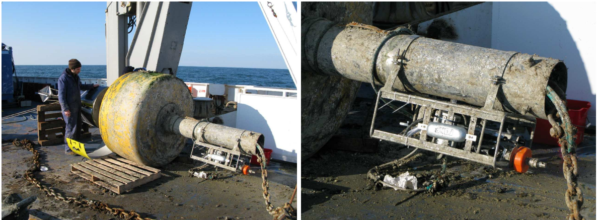
Figura 11: Boa S1, operazioni di ripristino corpo boa e cestello oceanografico.
