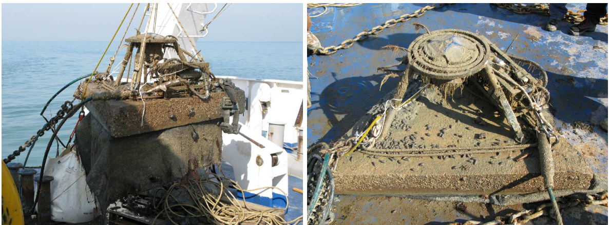
Figura 12: Boa S2, recupero del Basamento strumentale di fondo.
