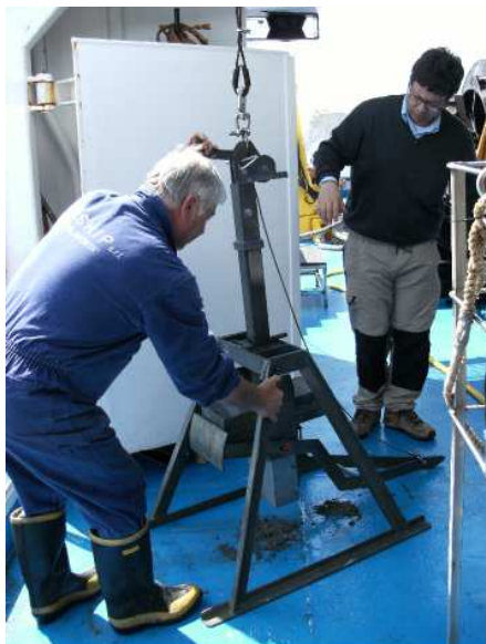
preparazione del box corer
