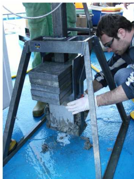
estrazione del box corer
