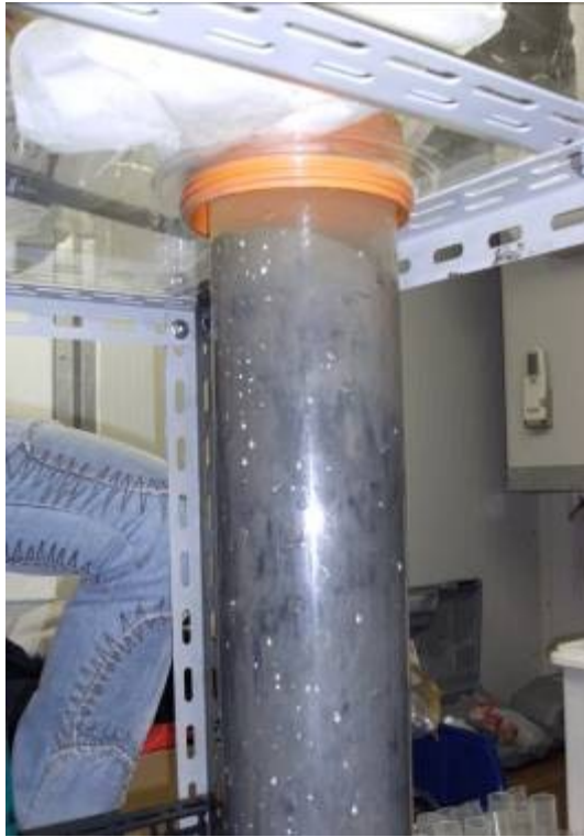
Estrusione (7): carota pronta per l'estrusione nella glove-box all'interno del container termostato.
