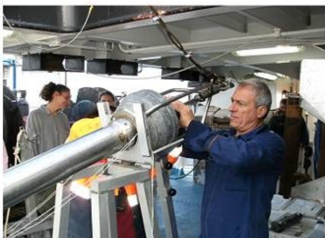
Carotaggio con SW104 (3): armamento del carotiere.
