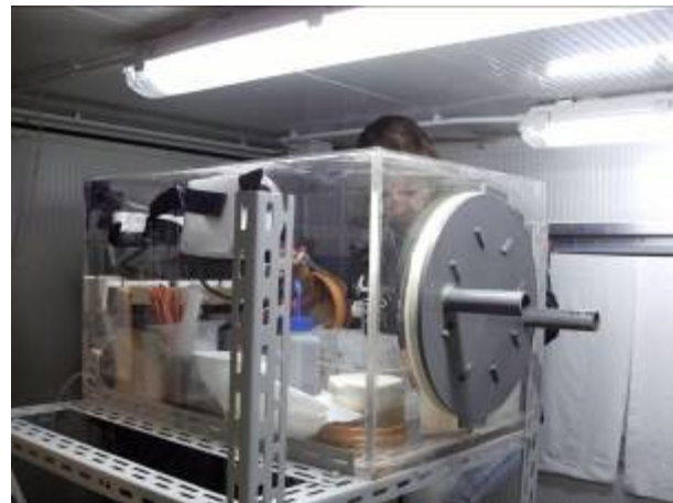
Estrusione (10): campionamento degli strati nella glove-box.
