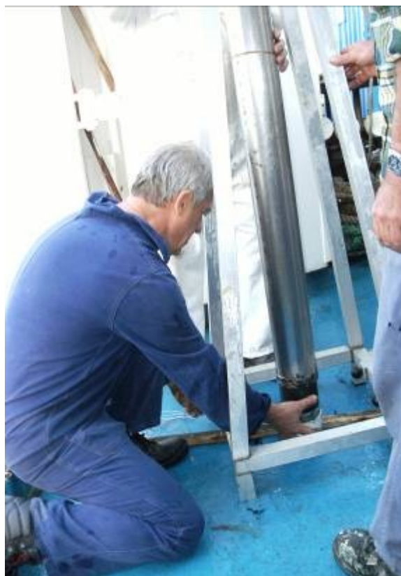
Carotaggio con SW104 (8): estrazione della carota.
