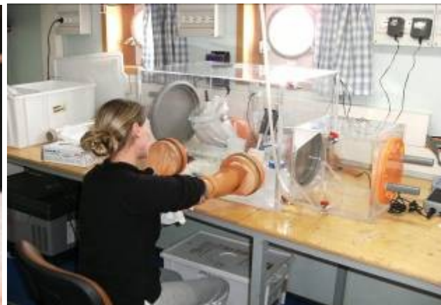
Estrusione (12): divisione delle aliquote delle acque interstiziali estratte dalla carota.
