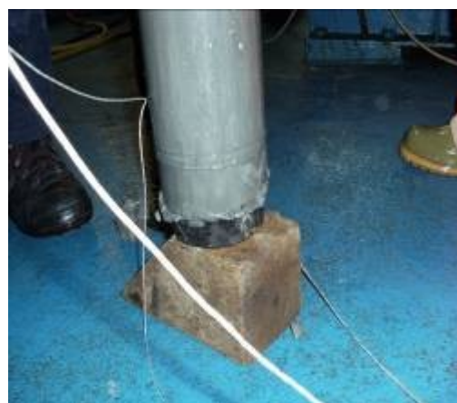
Estrusione (4): inserimento del pistone di estrusione nella carota.
