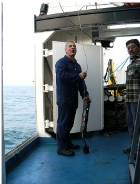
Campionamento dell'acqua di fondo con bottiglia niskin modificata
