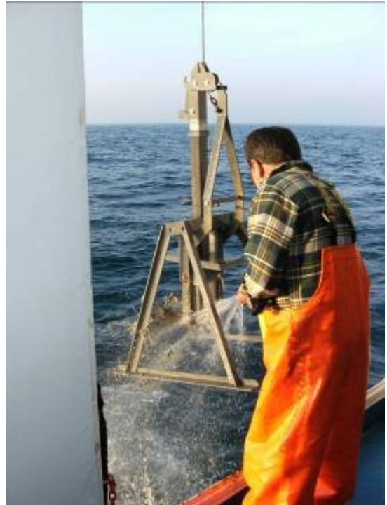
Box-corer (2): recupero del box-corer.
