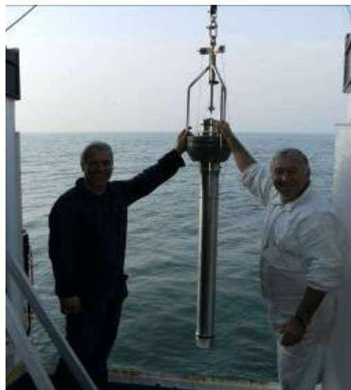
Carotaggio con SW104 (4): carotiere a mare pronto per il carotaggio.
