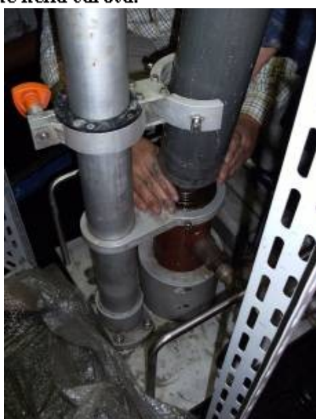
Estrusione (5): inserimento della carota nell'estrusore.
