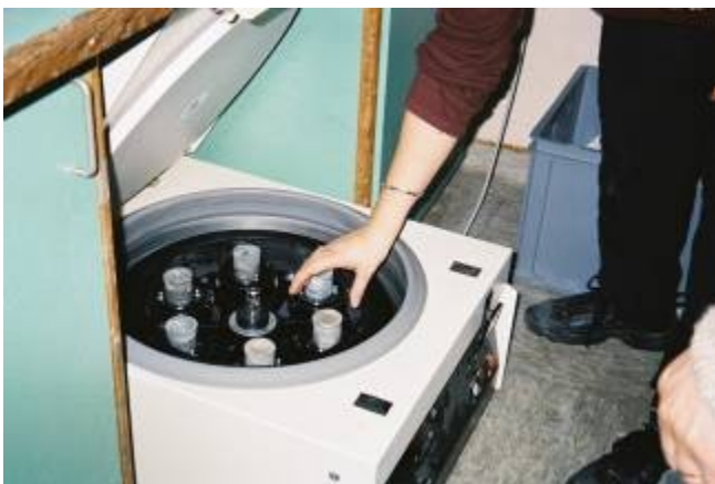
Estrusione (11): centrifugazione del sedimento estruso per estrazione delle acque interstiziali.
