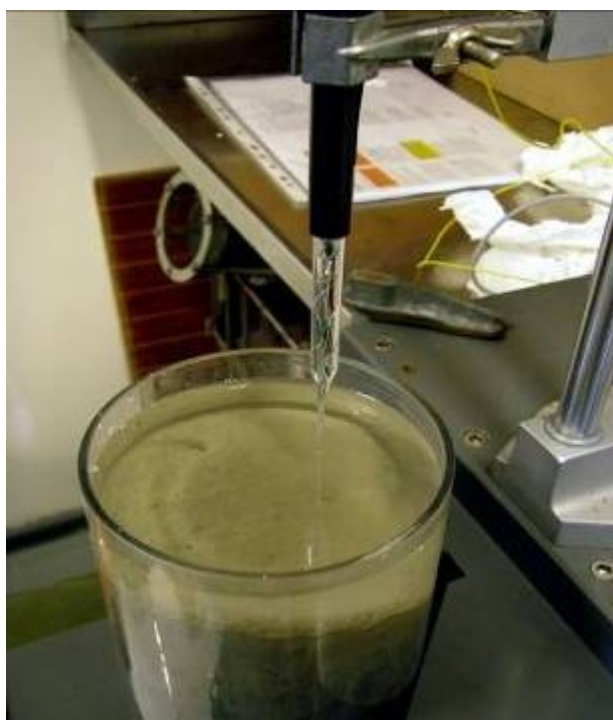
Micropofilatore di ossigeno disciolto (2): microelettrodo immerso nella carotina sub-campionata.
