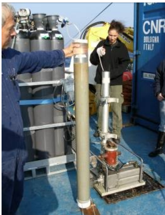
Estrusione (1): carota pronta per essere installata nell'estrusore.
