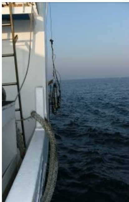
Profilo CTDOF, il profilatore è pronto per essere calato in mare.
