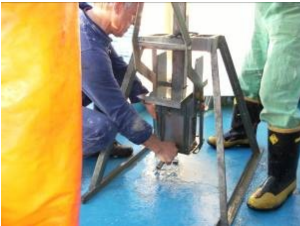
Box-corer (4): sub-campionamento del box-corer con carotina.
