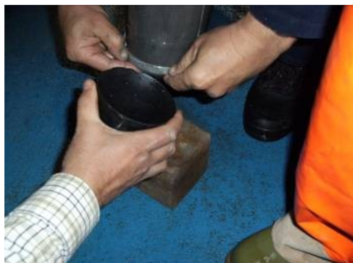
Estrusione (2): inserimento del pistone di estrusione nella carota.
