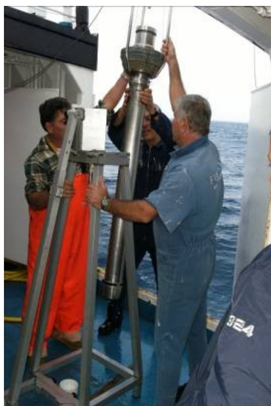
Carotaggio con SW104 (7): recupero del carotiere.
