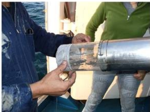
Carotaggio con SW104 (1): armamento del carotiere con preparazione della tela del naso.
