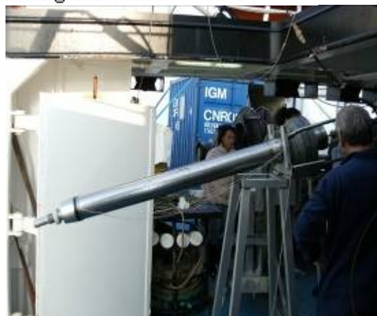
Carotaggio con SW104 (2): armamento del carotiere.
