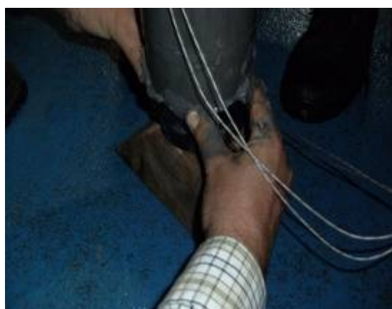
Estrusione (3): inserimento del pistone di estrusione nella carota.
