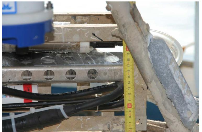
Figura 7: Basamento armato amagnetico per ADCP e Livello Oceanografico 2.
