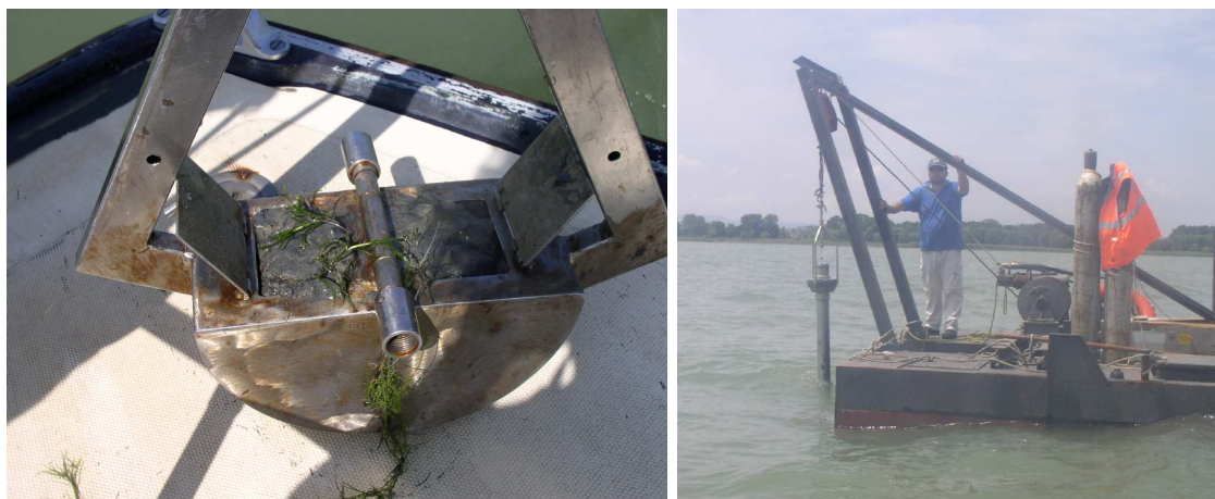
Figura 15: Benna Van-Veen modificata, vol.5L (sinistra). Carotiere ISMAR SW-104 (destra).
