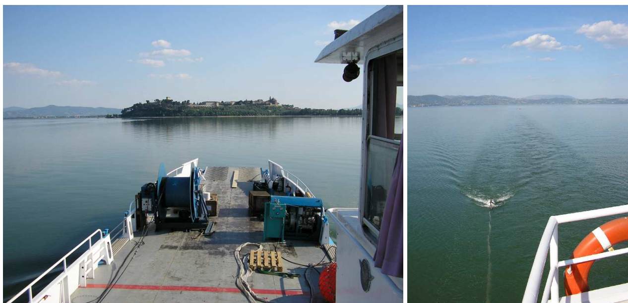
Figura 11: La M/N Grifone della Amm.Provinciale di Perugia. (sinistra): il rullo per il cavo sismico e il compressore. (destra): la sorgente sismica S15 trainata sul lato di dritta; si vede anche la boa di segnalazione fine cavo sismico.
